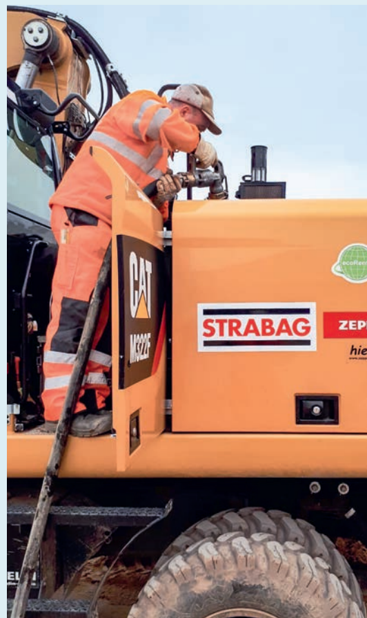
Erfassung des Treibstoffverbrauchs von Baumaschinen
