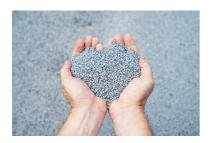
Eines der 400 Nachhaltigkeitsprojekte ist der ClAir®-Asphalt: das von STRABAG selbst entwickelte Material senkt über den Prozess der Photokatalyse die Konzentration giftiger Stickoxide wie zum Beispiel Stickstoffdioxid (NO<sub>2</sub>) in der Luft und dämpft durch seine spezielle Textur die Reifenabrollgeräusche erheblich.
