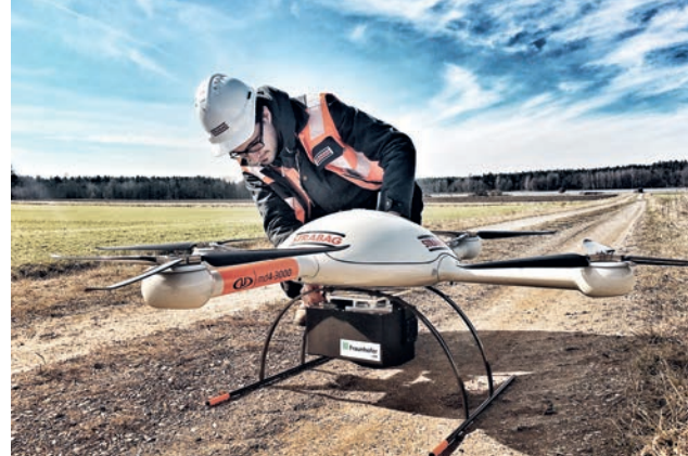
Digitale Vermessung mittels Drohnen
