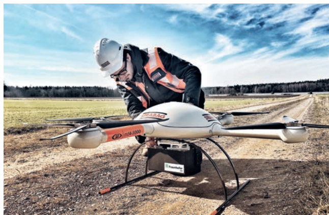
Digitale Vermessung mittels Drohnen
